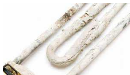
topné těleso s usazeninami
