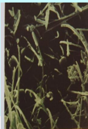
10 000 násobné zvětšení vysoce porézní hmoty Linde M I (snímek pořízen rastrovacím elektronovým mikroskopem)
